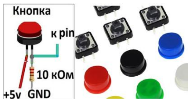
Рис. 1. Схема подключения тактовой кнопки к микроконтроллерной плате
